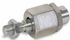
Raccordo flessibile per il montaggio snodato dello stelo del pistone. Il raccordo flessibile è destinato a disassamenti angolari fino a  $\pm 4^\circ$ .
